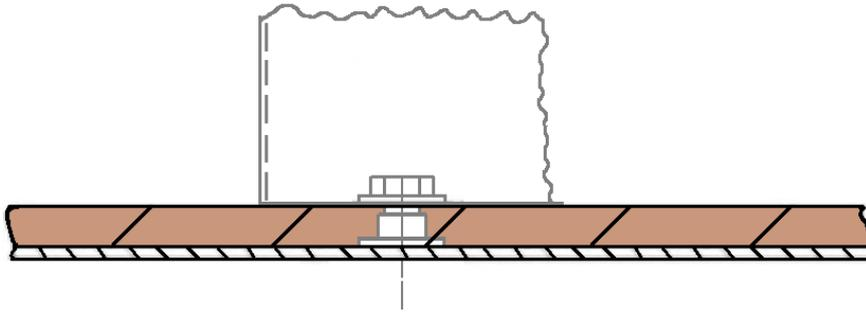
1. Marquer les trous existants du profil de montage sur le plancher en bois de 12 mm, sous le système de tiroirs BEKS.
